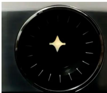
图 4-4 快门速度 1/2000 时，叶片开合图
