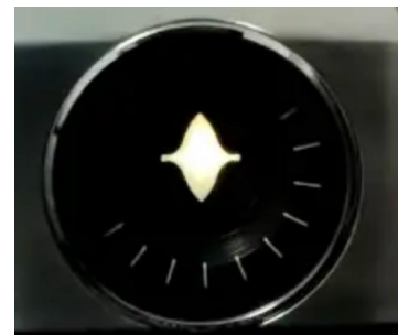
图 4-5 快门速度 1/500 时，叶片开合图
